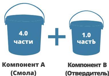
Состав готовят, смешивая дозированный объем компонента «А» (эпоксидная смола) с дозированным объемом компонента «В» (отвердителя) при механическом перемешивании до получения однородной массы – примерно 3 мин. Если нужно приготовить другое количество эпоксидного состава, то эпоксидную смолу и отвердитель берут в весовом отношении.
