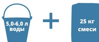
◆ Добавить порошок **РЕКС® КЛЕЙ 55** в емкость с чистой водой и перемешать вручную (при массе затворяемой смеси не более 1 кг) или смесительной установкой/электродрелью с насадкой до получения однородной массы без комков и сгустков в течение 3-5 минут.
